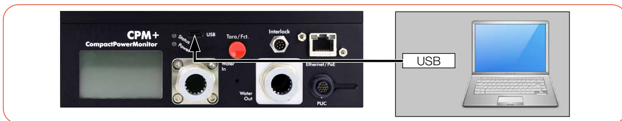
Abb. 7.3: Spannungsversorgung über USB, Datenübertragung über USB
