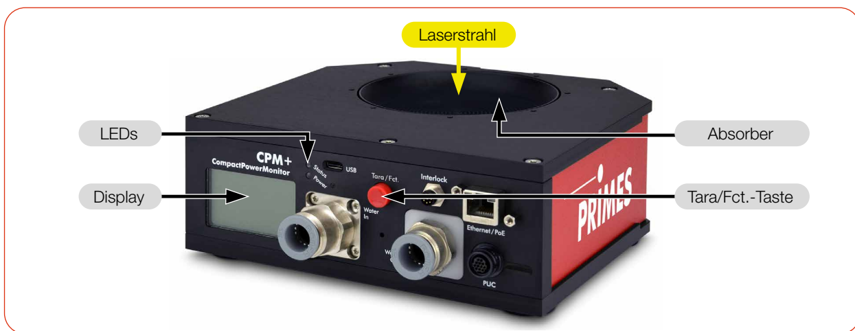
Abb. 4.1: Funktionsbeschreibung (am Beispiel des CPM+ F-10)
