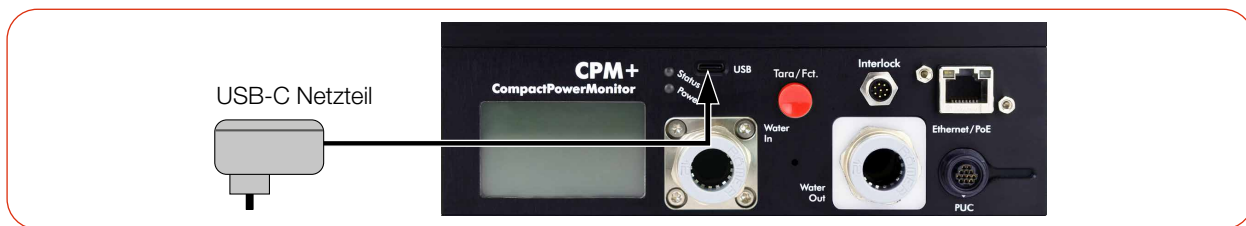
Abb. 7.2: Spannungsversorgung über USB-C Netzteil, Anzeige der Messwerte am Gerät
